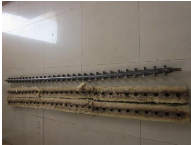
Obrázek C.2: Fotografie závěsu a izolace (po zkoušce)
